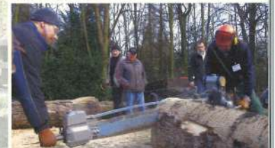
Stihl-B2Z-Nachbau: Die kann am Stamm richtig zuschlagen - dank Zweizylinder-Boxermotor
