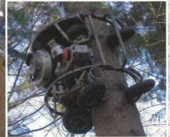
Ohne Robotergehirn: Die F & S-Klettersäge „fährt“ rein mechanisch die Stämme hoch
