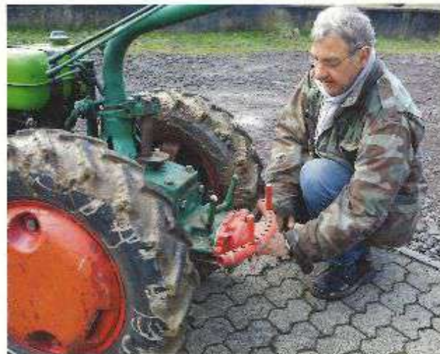
Verwandlungskünstler: Mit gerade mal zwei Schrauben löst Karl-Heinz Hennens die Ackerschnecke. Dahinter läuft die Zapfwelle, die beiden Kugelköpfe dienen zum Zentrieren der Arbeitsgeräte
