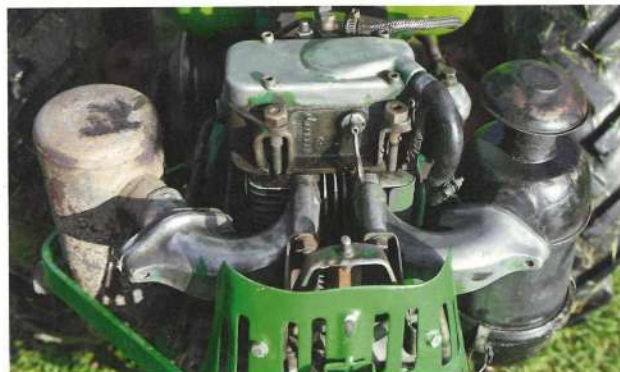
Westfälisches Zugpferd: Die zehn PS des Berning bringen Agria leistungsmäßig an die Spitze des Marktes – völlig ohne Zweitaktfahne. Der Diesel ist robust, sparsam und wartungsfreundlich
