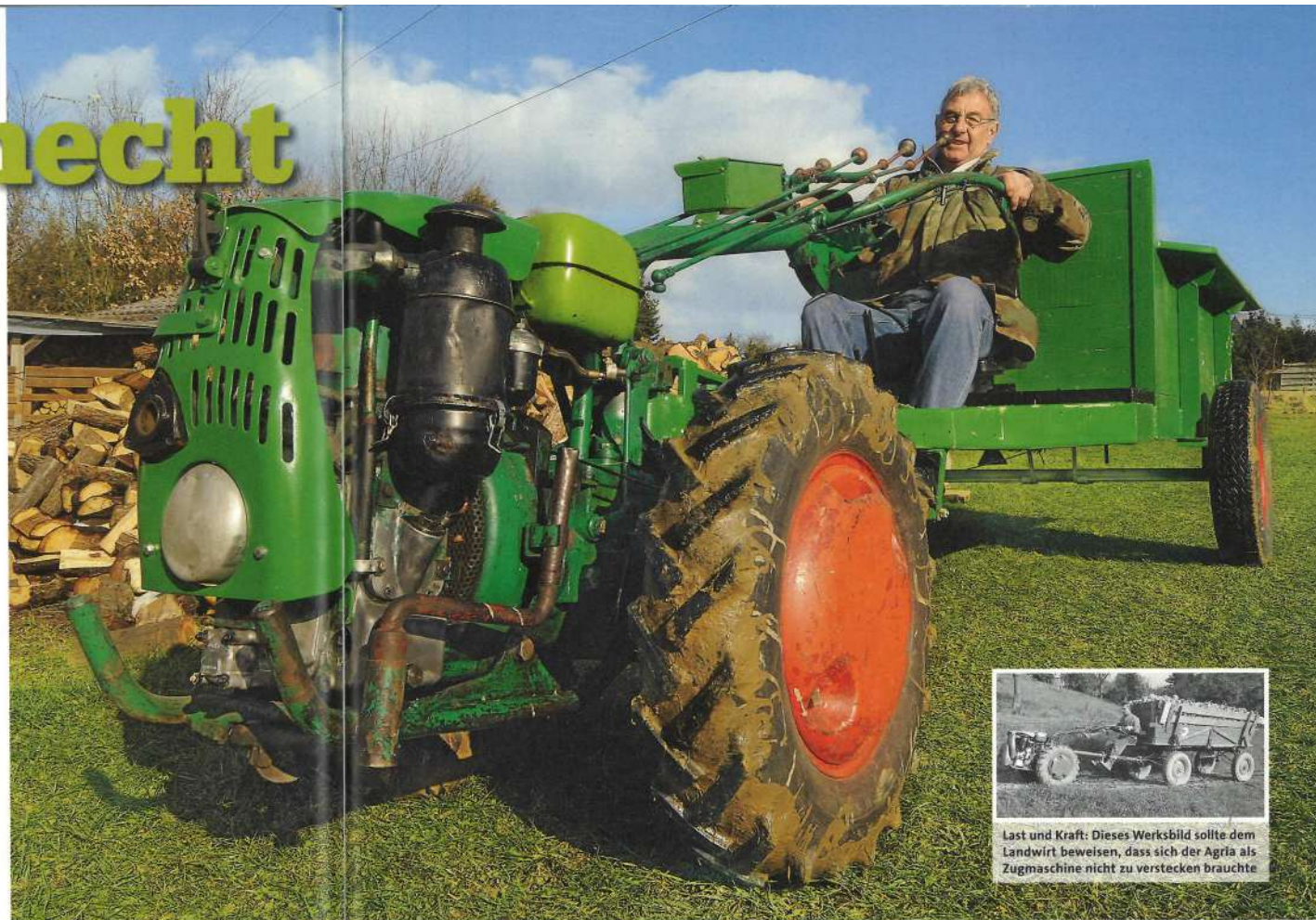
Durch dick und dünn: Dank aktivierter Differentialsperre meistert der Agria 2800 D auch schwere Böden – selbst mit Anbaufräse
